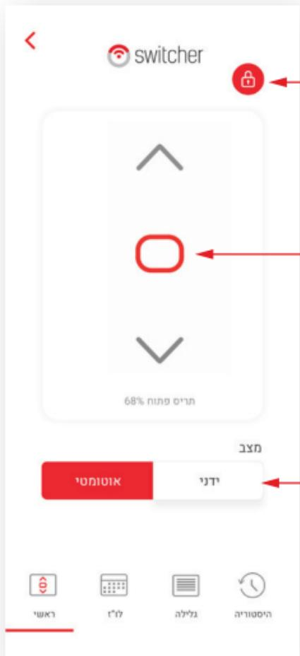
**נעילת המתג** – לחיצה על המנגול באפליקציה תנעל את המתג ולא תאפשר בו שימוש ידני או מהאפליקציה קצה. לחיצה נוספת על המנגול נספתת על המנגול ותחרור את הנעילה.
